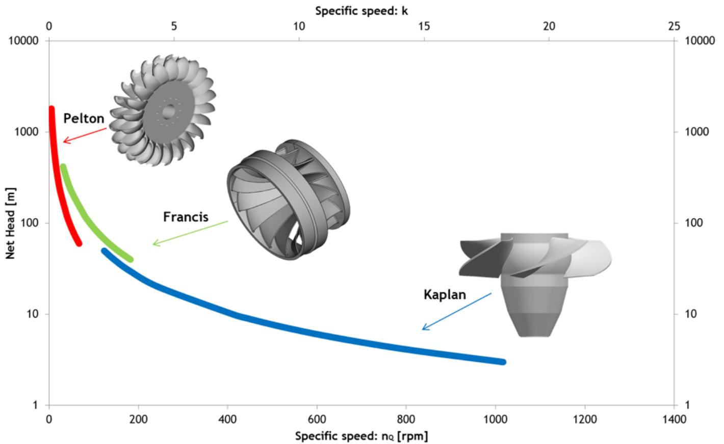
Le turbine idrauliche sono macchine che lavorano usualmente a velocità di rotazione  $n$  costante funzione della frequenza  $f$  del generatore elettrico sincrono accoppiato alla turbina. Nel caso di frequenza  $f = 50$  Hz, la velocità di rotazione  $n$  è data da:
